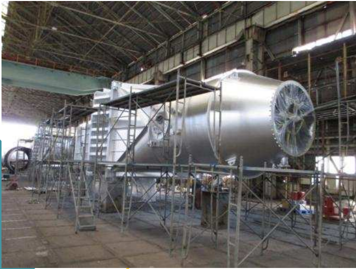
雑固体廃棄物焼却設備
